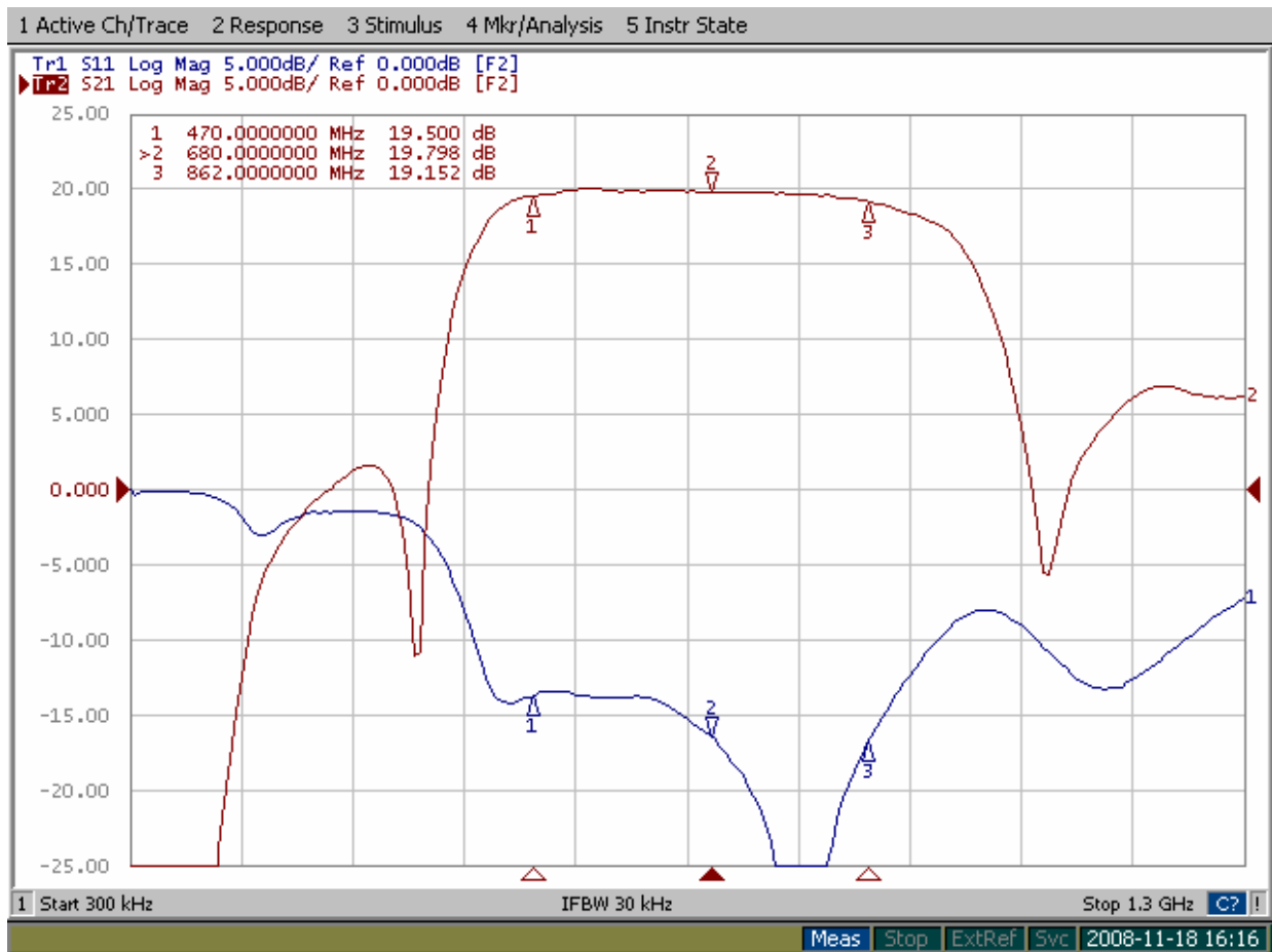
ZA-20 sobituse (S11) ja ülekande (S21) karakteristikute näidis.
