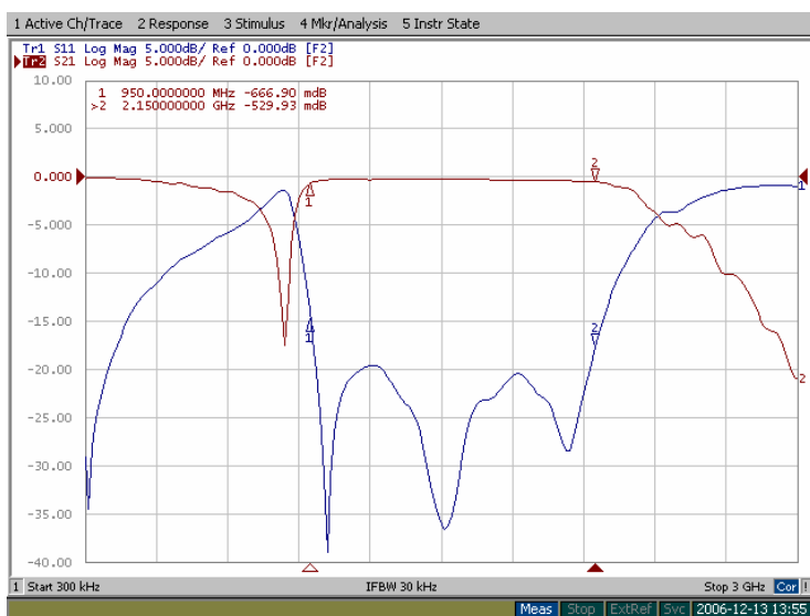
Joonis 2. Näide S21 ja S11 karakteristikutest
